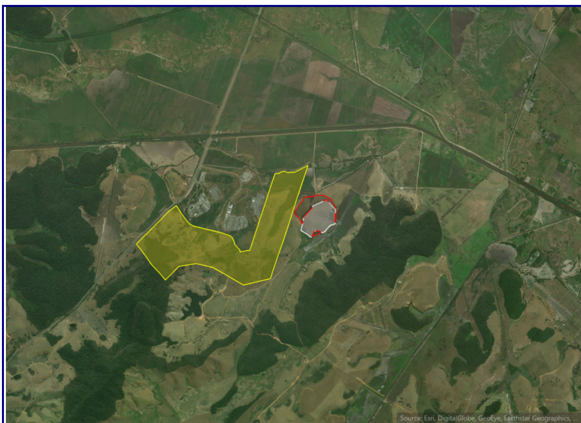
FIGURA 5.7.5-2: FAIXA DE TERRA EM TORNO DA UTE (LINHA VERMELHA EXTERNA), PARA ESTABELECEER UM BUFFER DE LARGURA NECESSÁRIA PARA PERMITIR O DECAIMENTO SONORO AOS NÍVEIS NORMALIZADO, NO LIMITE DA CERCA DO TERRENO, CONSIDERANDO PROJETO DE LEI COMPLEMENTAR (PLC) Nº E – 013/2017
