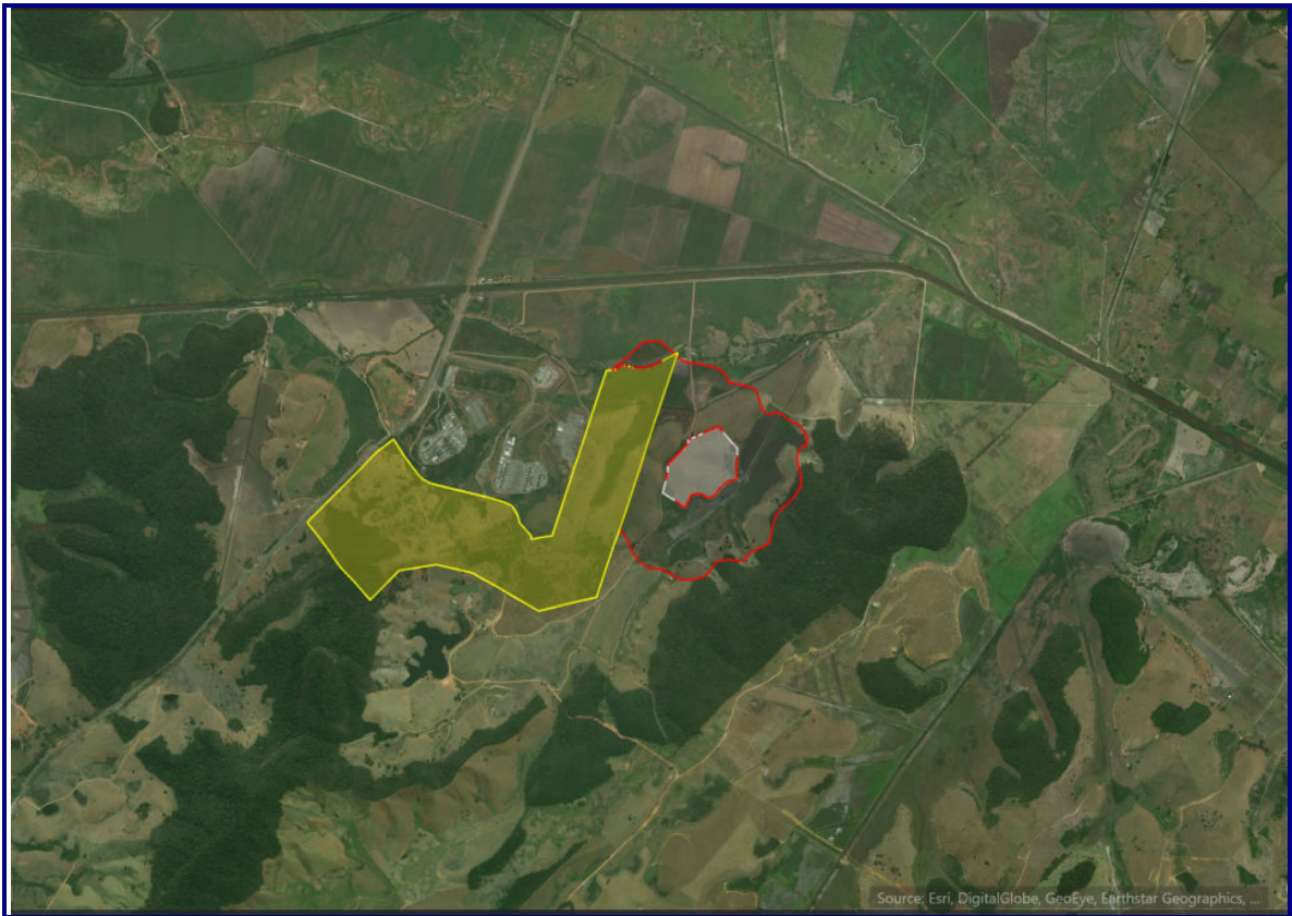
FIGURA 5.7.5-1: FAIXA DE TERRA EM TORNO DA UTE (LINHA VERMELHA EXTERNA), PARA ESTABELECECER UM BUFFER DE LARGURA NECESSÁRIA PARA PERMITIR O DECAIMENTO SONORO AOS NÍVEIS NORMATIZADOS, NO LIMITE DA CERCA DO TERRENO, CONSIDERANDO A ATUAL LEGISLAÇÃO MUNICIPAL.
